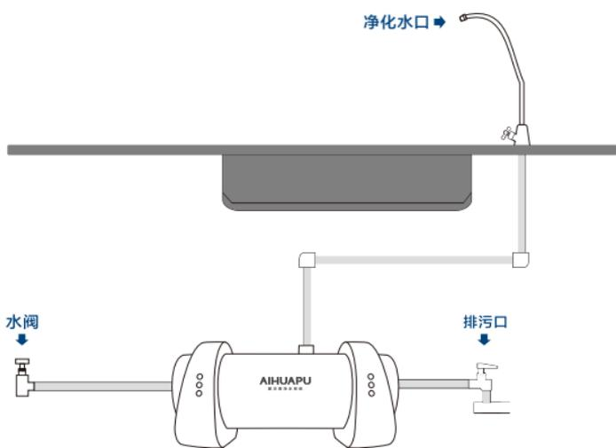
⚠ 机器安装时,严禁使用机器自带的一次性密封堵头做为排污口堵头
